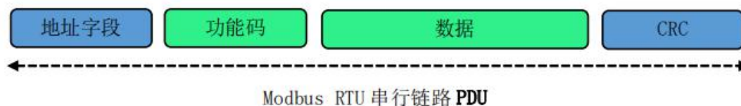
图 7-2 串行链路上的 Modbus 帧
